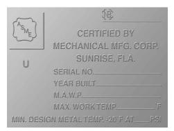
Placa Código ASME-identifica el "National Board Number" y el Numero de Serie de la carcaza. Un Estampado "U" indica que la carcaza fue diseñada y Manufacturada bajo las normas del código ASME, Sección 8, División 1. Los límites de presión y temperatura están designados en la placa. Cualquier reparación o modificación a la carcaza con placa de Código ASME nulifica la certificación de la carcaza.
